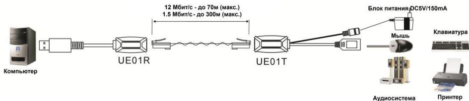
Рис. 5 Схема подключения передатчика UE01T и приёмника UE01R.
